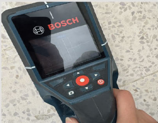
صورة #6: محتوى مائي مرتفع بارضية السطح
