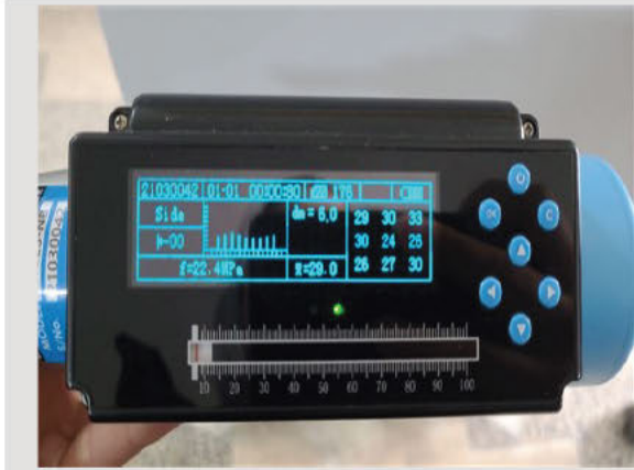
صورة 2# : قوة كسر الخرسانة جيدة للعمود 2
