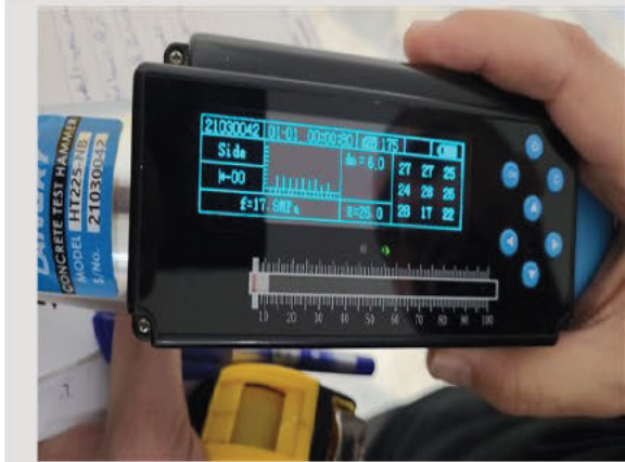
صورة 4# : قوة كسر الخرسانة جيدة للعمود 4
