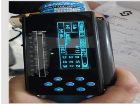
صورة 1# : قوة كسر الخرسانة جيدة للعمود 1
